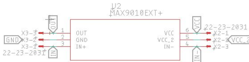
Abbildung 30: Effekte Pinbreakout: Eagle Schematic
