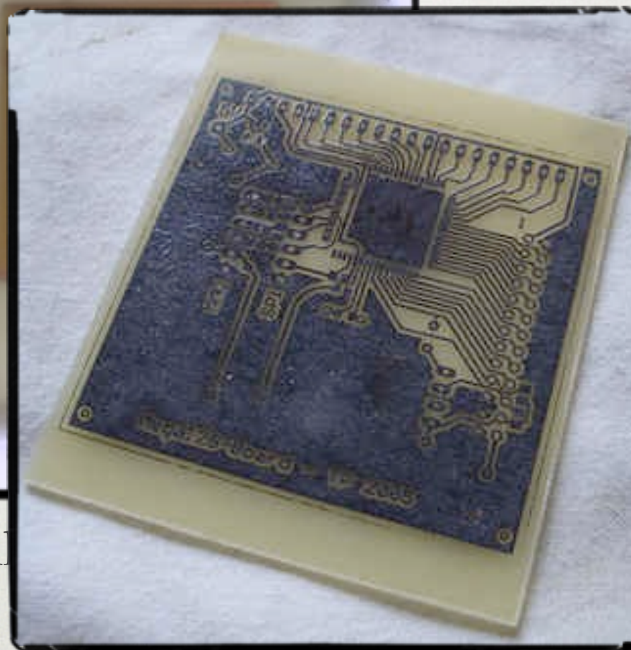
Platine nach dem Ätzen noch mit Toner
