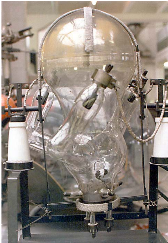
Quecksilberdampfgleichrichter mit drei Armen in der Haupthalle des Technisches Museum Wien Baujahr: 1923.
