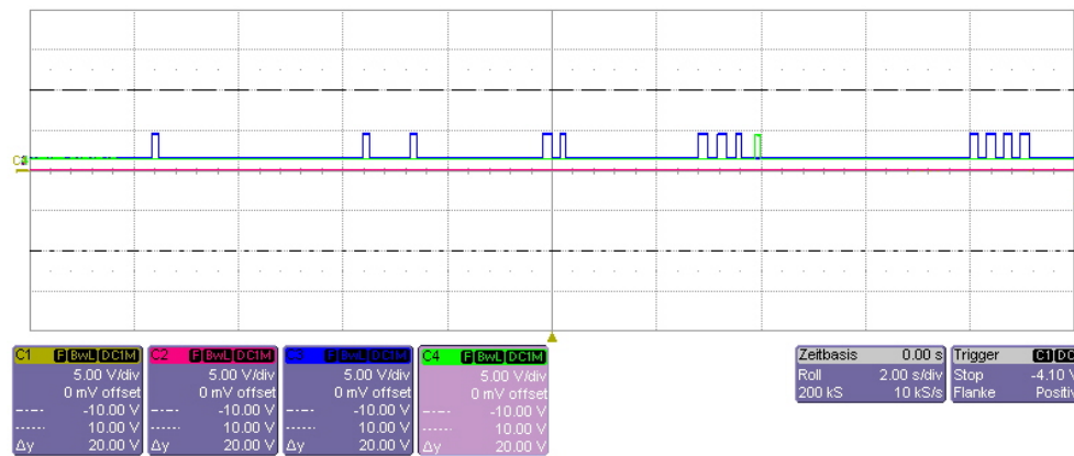
Abbildung 9.46: Klatschimpulse am Logik-Eingang
