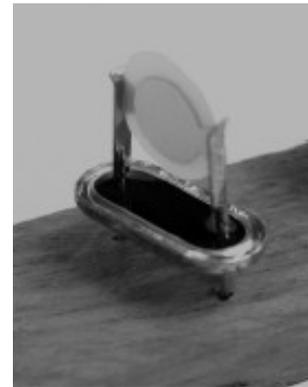
Rein elektrisch gesehen verhält sich der Quarz dabei wie ein Serienschwingkreis. Genau diese Eigenschaft machen sich die Rückkopplungszirkularen zunutze denn ein Schwingkreis hat bei Resonanz eine Phasenverschiebung von  $180^\circ$ , die weiteren  $180^\circ$  Phasenverschiebung erreicht man durch invertieren der Wechselspannung, nun braucht man nur noch einen Verstärker der in der Lage ist den Innenwiderstand des Quarzes im Kreis zu kompensieren.
