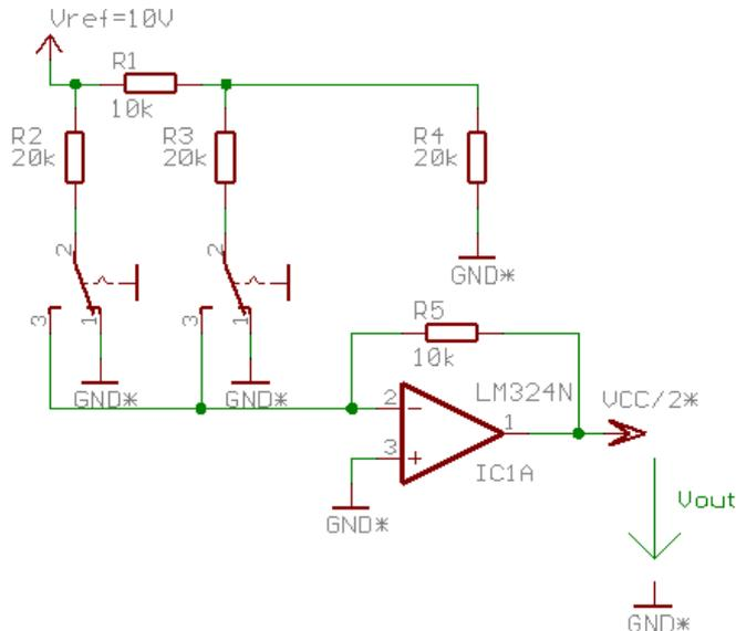
Auf solch ein R2R-Netzwerk baut jeder DA-Wandler auf. Die Schalter sind digital gesteuert, jeder Schalter ist ein Bit vom Eingang. Der OP muss meist extra angeschlossen werden, da solche DA-Wandler einen Strom und keine Spannung ausgeben.
