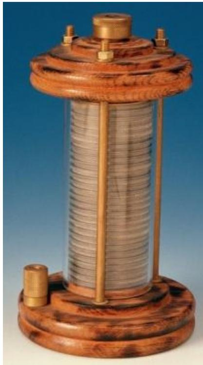
Die Urform des Akkumulators baute 1802 Johann Wilhelm Ritter. Der unter dem Namen "Rittersche Säule" bekannte Versuchsaufbau konnte mit elektrischem Strom geladen werden und gab diesen bei der Entladung wieder ab. Die Säule bestand aus Karton- und Kupferscheiben, die in einem Gefäß mit einer Salzlösung lagen.
