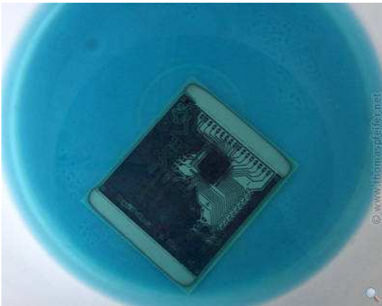
Abbildung 6: Ätzen zu Hause mit NaPS (Natriumpersulfat) im Putzeimer (links) und Geätzte Platine mit Toner (rechts)
