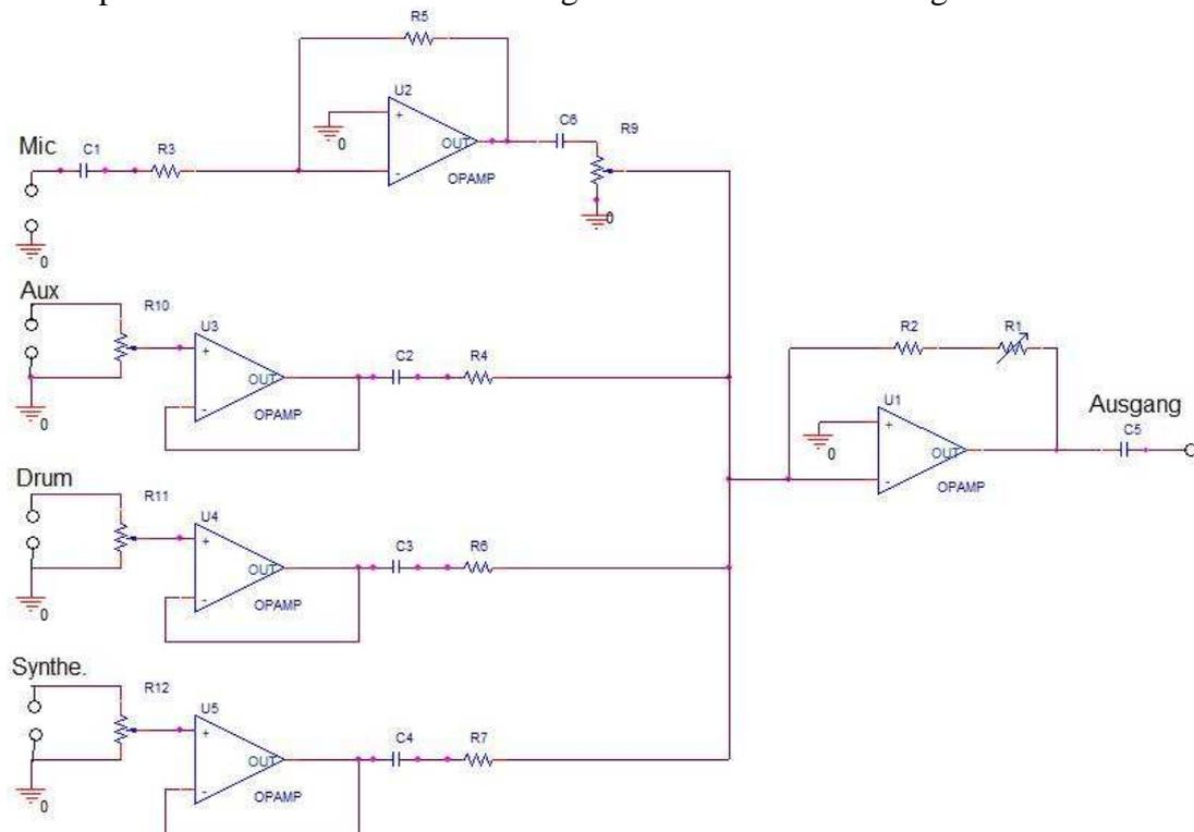
■ Potentiometerschaltung zur Balancesteuerung:
