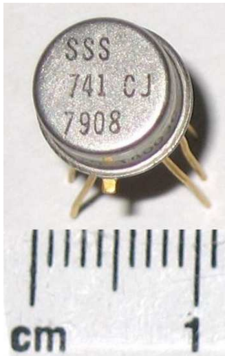
Abbildung: 741 aus dem Jahr 1979 in einem TO-5-Metallgehäuse, Quelle Wikipedia Link http://upload.wikimedia.org/wikipedia/commons/9/92/741_op-amp_in_TO-5_metal_can_package_close-up.jpg
