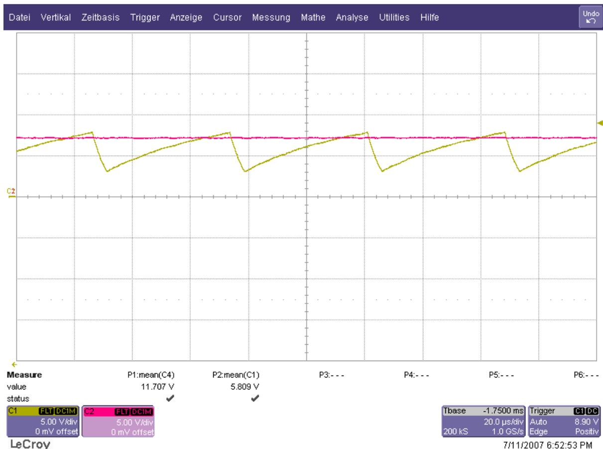
Abbildung 61: Eingänge des Komparators
