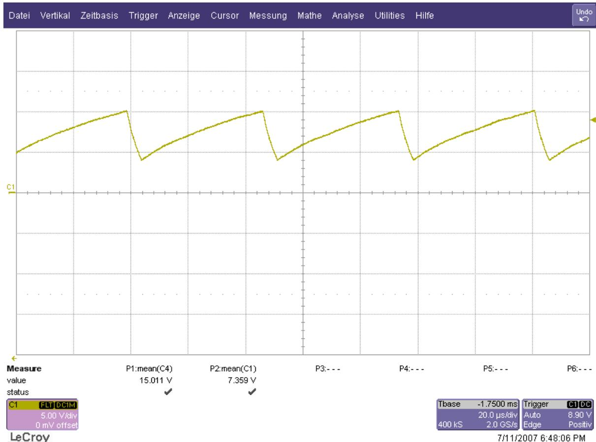
Abbildung 58: Oszilloskop-Messung Sägezahnspannung
