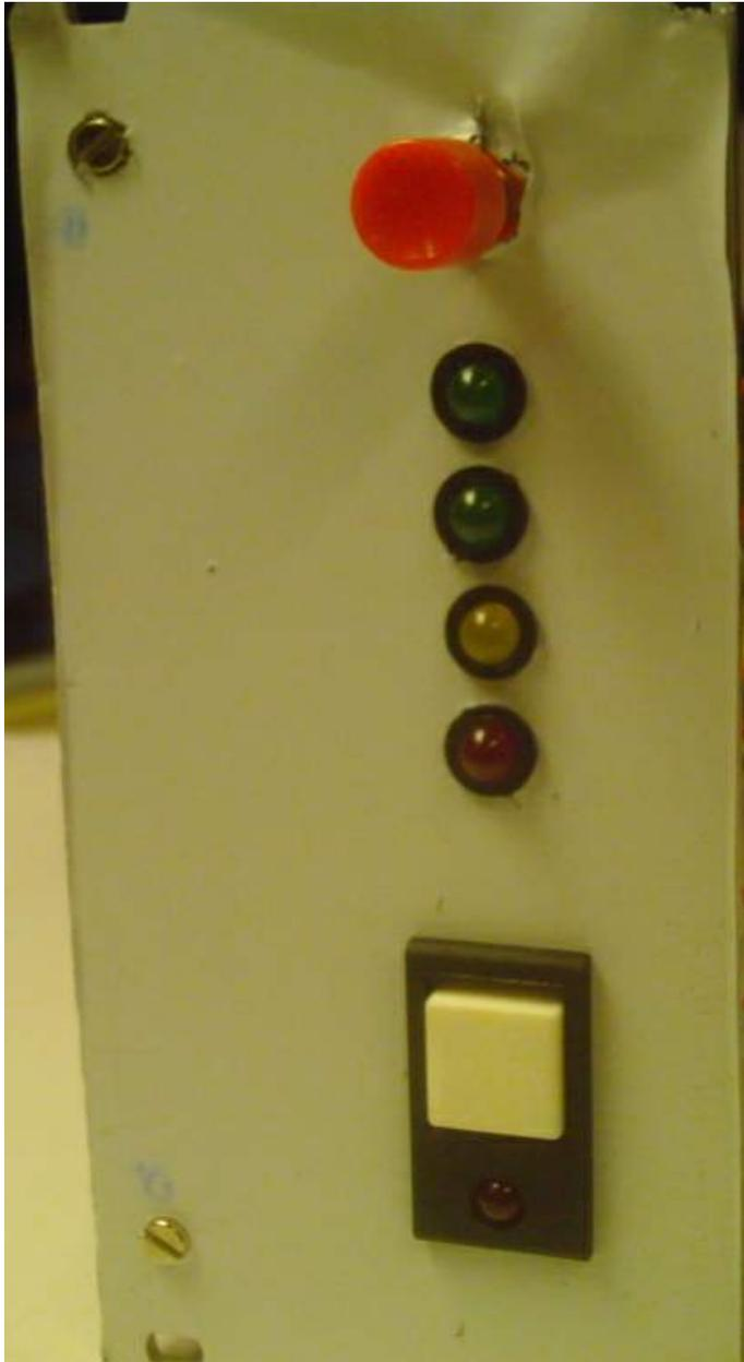
Im oberen Bereich ist ein Taster zu finden (der rote Knopf). In der Mitte sind vier Leuchtdioden angebracht und im unteren Bereich ist ein weiterer Taster mit integrierter roter Leuchtdiode.
