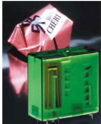
Moderne Relais können bei einer Antriebsleistung von 0.5W Stromstärken von 5mA bis 6A (bei 1500W Leistung)schalten.
