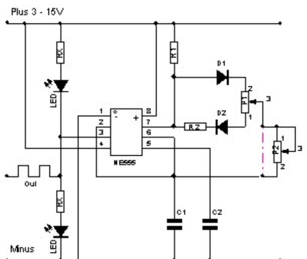
Mit dem Rechtecksignal am Ausgang können bereits Leuchtdioden betrieben werden. Um größere Lasten zu treiben, müsste an den Ausgang z.B. ein MOSFET gelegt werden.
