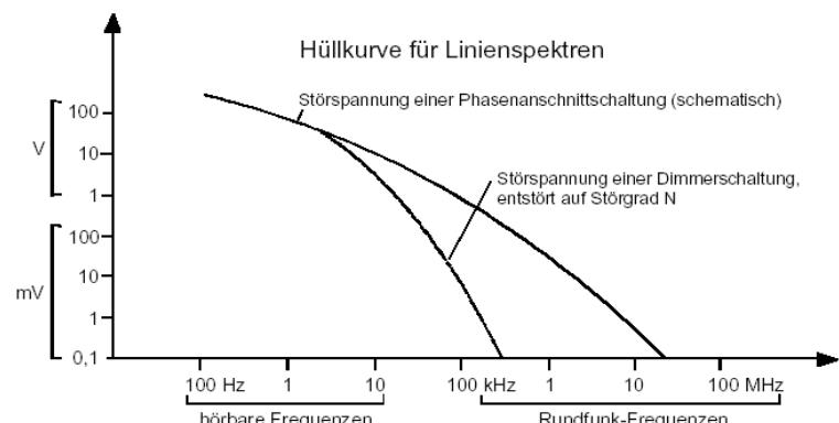
Phasenanschnittsdimmer eignen sich nicht zum Steuern von Transformatoren, da sich durch die Entstörmaßnahmen am Dimmer mit dem Transformator Schwingkreise unterschiedlicher Resonanzfrequenzen bilden, die zu Funktionsstörungen und Beschädigung der Schaltungen führen können.
