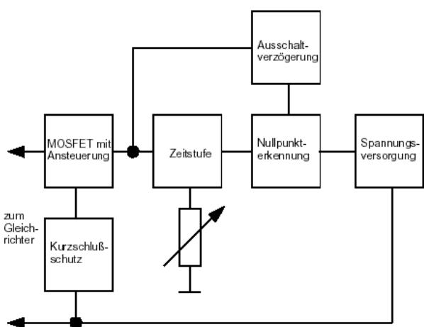
Eine Beispielschaltung wird nun anhand eines Blockschaltbildes erläutert. Als Schalter wird ein MOSFET verwendet, der durch die Zeitstufe angesteuert wird. Die Zeitstufe kann z.B. durch einen Monoflop realisiert werden, der den Transistor für eine Zeit durchschaltet, die über das Potentiometer eingestellt wird. Die Nullpunktserkennung sorgt für eine korrekte Taktung des Monoflops.
