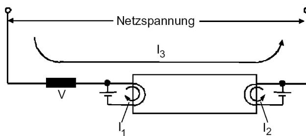
Das Dimmen von Entladungslampen ist grundsätzlich nur mit speziellen Vorschaltgeräten möglich. Um die Gasentladung zu ermöglichen, muss durch die Glühelektroden der Lampen ein gewisser Heizstrom fließen, damit Elektronen emittieren. Wird nun ein Dimmer ohne Zusatzschaltung vor die
