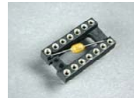
Abbildung 1.3.3: IC-Fassung mit Abblockkondensator für digitale Schaltungen.
