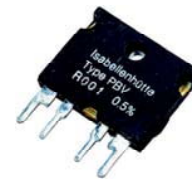
Abbildung 1.1.11: Präzisionswiderstand zur Strommessung. Um Messfehler zu vermeiden mit 4 Anschlüssen.
