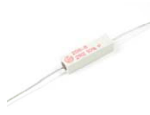
Abbildung 1.1.7: Drahtwiderstand im Keramikgehäuse. Kennzeichnung durch Aufdrucke.
