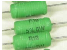
Abbildung 1.1.8: Drahtwiderstände für 5W. Kennzeichnung durch Aufdrucke.
