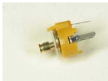
Abbildung 1.3.4: Einstellbarer Folienkondensator
