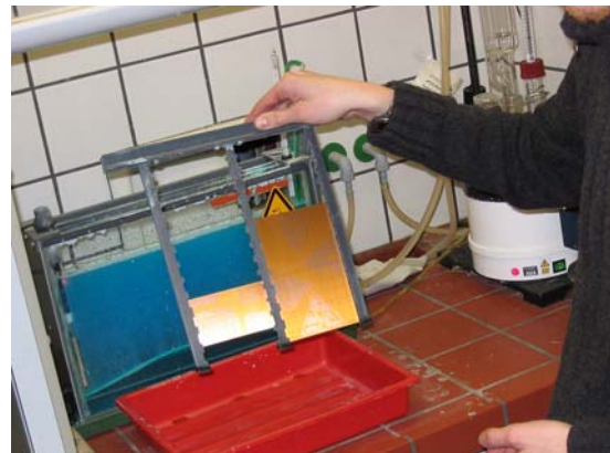
Abbildung 65: Aetzen der PWM-Platine
