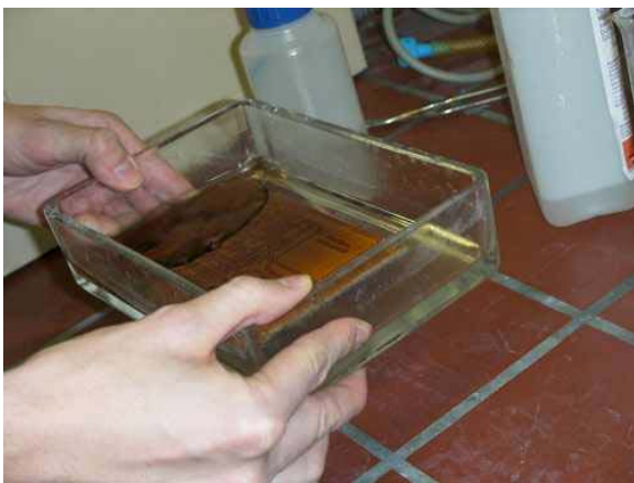
Abbildung 42: Die Zufallsplatine im Entwickler
