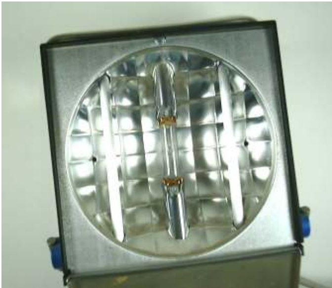
Eine ausgemusterte Höhensonne ermöglicht die Belichtung von Platinen in weniger als 2 Minuten
