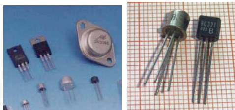
Abbildung 1.4.3: Transistoren in verschiedenen Gehäusen: (v.l.n.r. obere Reihe) TO126, TO220, TO3, TO39, T92
