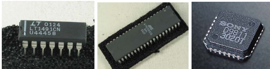
Abbildung 1.4.2: ICs in verschiedenen Gehäusen. von links nach rechts: DIP (Dual-In-Line) 14, DIP40, PLCC
