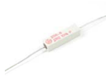
Abbildung 1.1.7: Drahtwiderstand im Keramikgehäuse. Kennzeichnung durch Aufdrucke.
