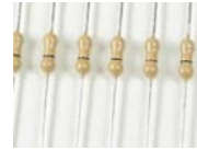
Abbildung 1.1.9: Kohleschichtwiderstände am Gurt. Kennzeichnung auch durch Farbcodes
