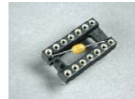
Abbildung 1.3.3: IC-Fassung mit Abblockkondensator für digitale Schaltungen.
