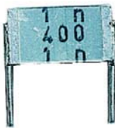
Abbildung 1.3.2: Ungepolte Kondensatoren.
