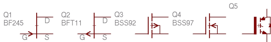
Abbildung 1.4.2: Schaltzeichen für selbstleitende N-Kanal und P-Kanal Fets (links), selbstsperrende N-Kanal und P-Kanal MOS-Fets (mitte) und einen IGBT (rechts).
