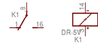
Abbildung 1.2.2: Schaltsymbol für ein Relais mit einem Umschaltkontakt.
