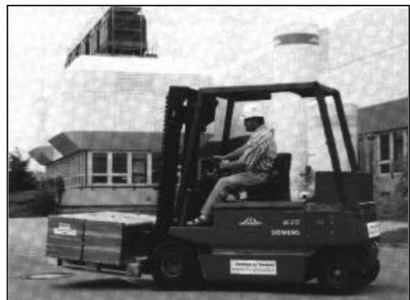
oben: Gabelstapler mit PEMFC-Antrieb; seit August 1997 bei der Solar-Wasserstoff-Bayern GmbH in Erprobung.
