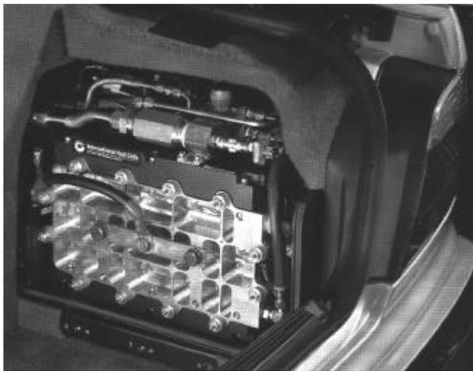
Eine Brennstoffzelle versorgt die Bordelektronik und andere Stromverbraucher.
