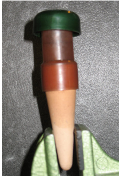
Abbildung 2.21.: Blumat-Tonkegel als Grundlage des Tensiometers
