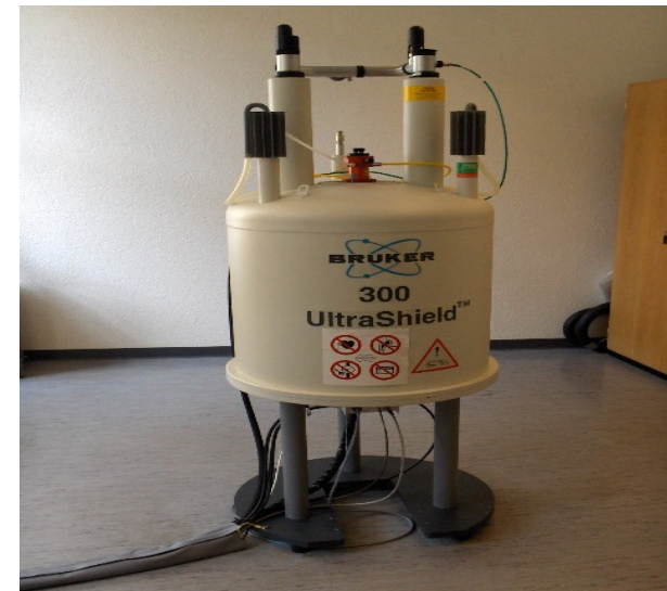
Abb. 21 Der Magnet eines 300-MHz-NMR-Spektrometers
