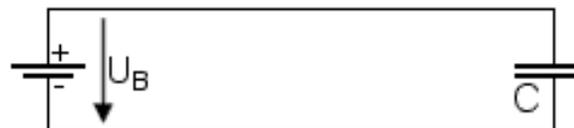
Betriebsspannung aufladen. Danach sperrt er Gleichstrom.
