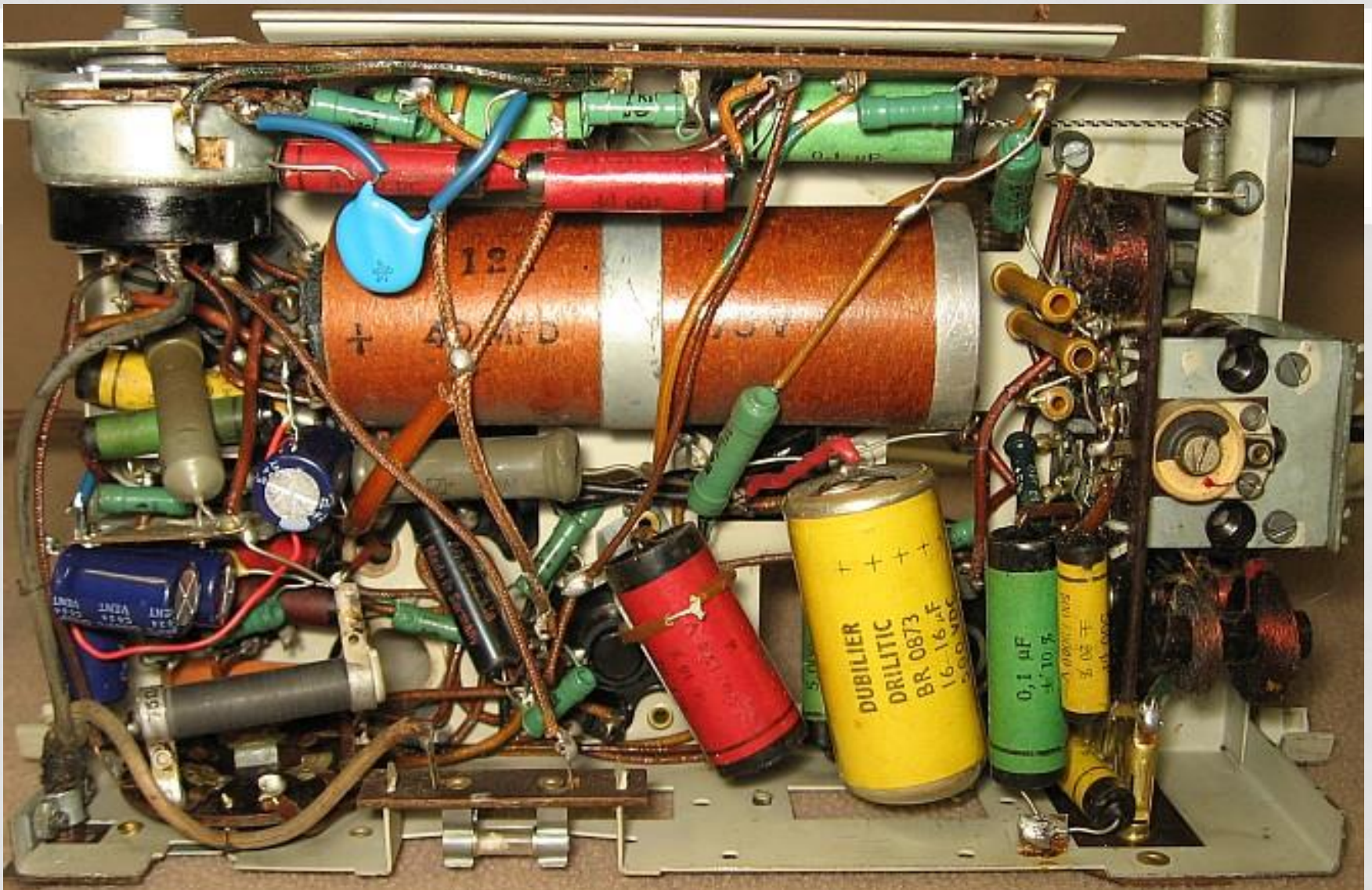
Bild: Verdrahtung im alten Radio
