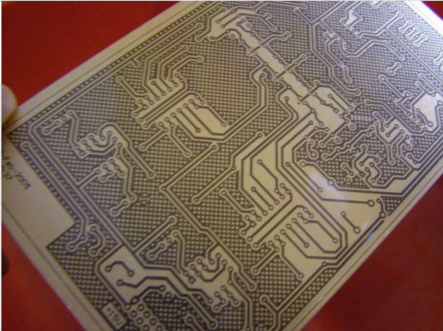
Bild: Platine nach Entwicklerbad
