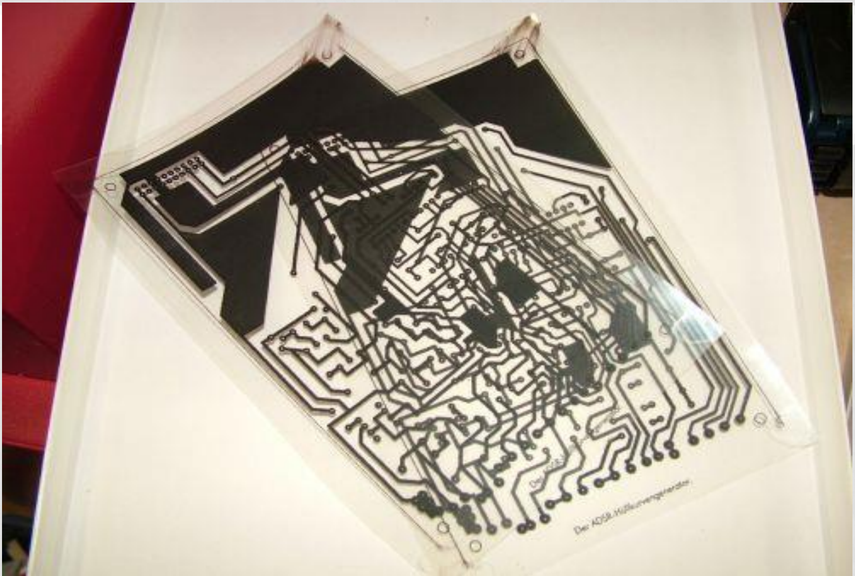
Bild: fertiges Layout auf Folie gedruckt
