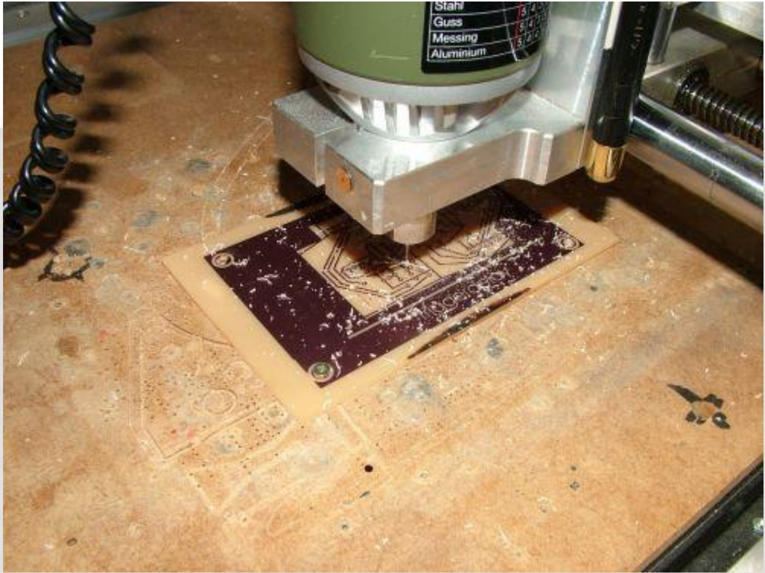
Bild: Bohren mit CNC- Fräse
