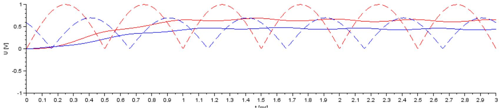
Gleichgerichtet und mit einem Tiefpassfilter 2. Ordnung mit Grenzfrequenz 500Hz
