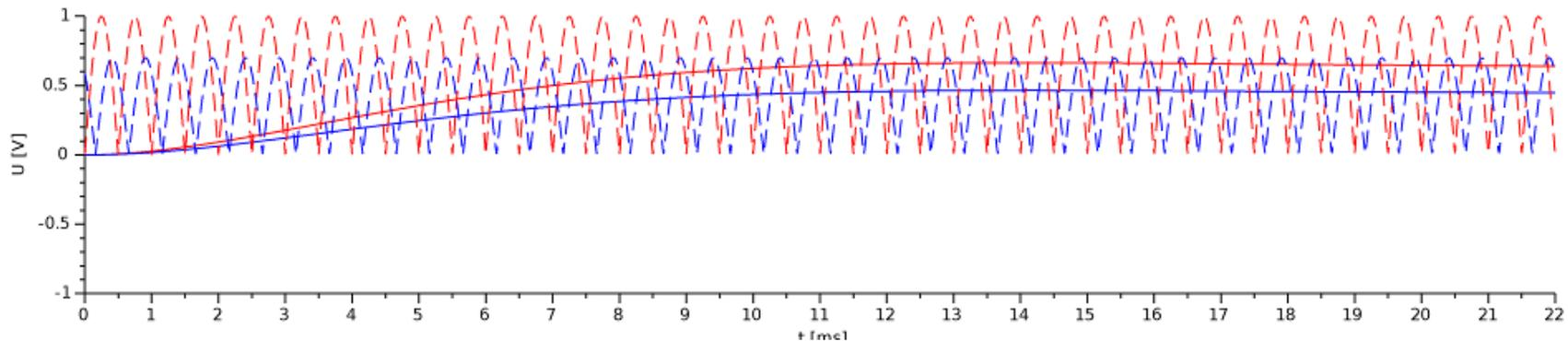
Gleichgerichtet und mit einem Tiefpassfilter 2. Ordnung mit Grenzfrequenz 50Hz
