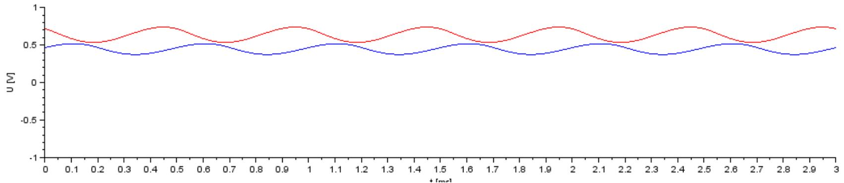
Zwei Signale mit unterschiedlicher Amplitude und versetzter Phase
