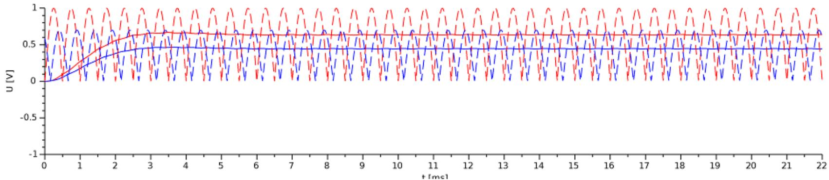
Gleichgerichtet und mit einem Tiefpassfilter 2. Ordnung mit Grenzfrequenz 200Hz
