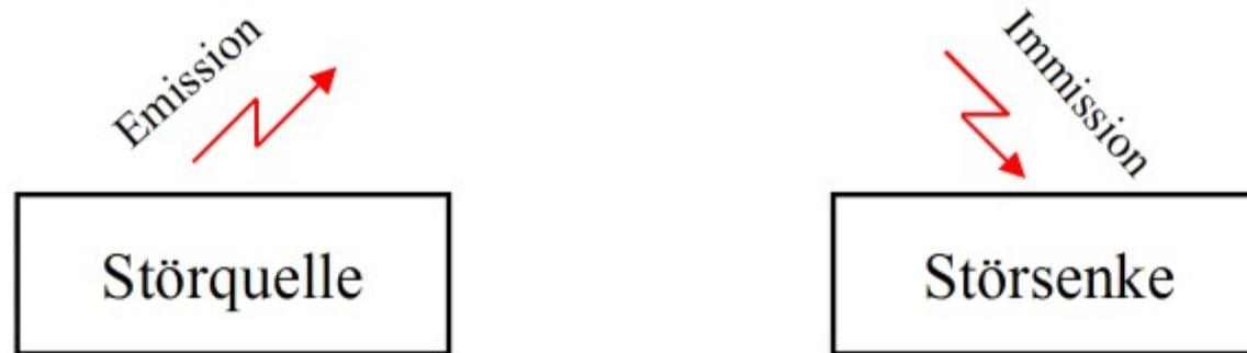
Ein technisches Gerät kann sowohl Störquelle (Verursacher eines Störsignals) als auch Störsenke (Empfänger eines Störsignals) sein.
