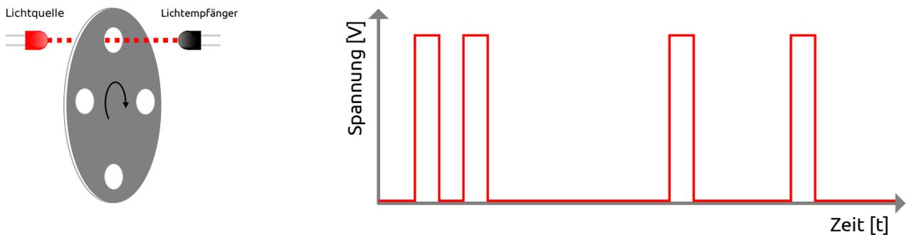
Zur Ermittlung der Drehzahl werden die Impulse ausgewertet. Hierzu kann über die Winkelgeschwindigkeit, welche definiert ist als die Winkeländerung über die Zeit, auf die Drehzahl geschlossen werden. Alternativ können auch die Impulse in einer festgelegten Zeit gemessen werden. Um die Auflösung und Genauigkeit der Impulsdrehzahlmessung zu verbessern, kann die Anzahl der Markierungen erhöht werden.
